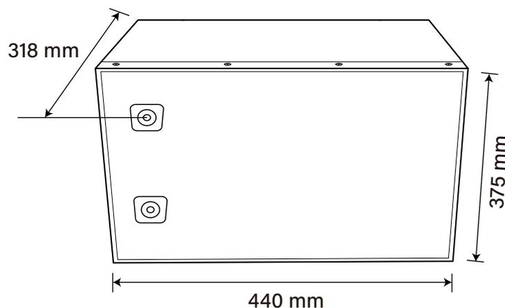
Dimensions avec les bornes L440 \* W318 \* H375 mm
