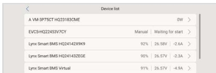
Une fois activée, l'EVCS apparaîtra dans la liste des appareils, où elle pourra être surveillée et contrôlée. Pour plus de détails, consultez le [manuel de la station de charge pour véhicule électrique](#).
