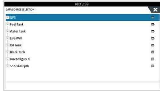
4. La sélection d'un capteur de réservoir dans le menu de sélection de la source de données permet d'obtenir des détails supplémentaires et des options de configuration telles que le type de liquide, l'emplacement ou la personnalisation du nom. Enfin, ouvrez un tableau de bord personnalisé et disposez les capteurs de réservoir comme vous le souhaitez.
