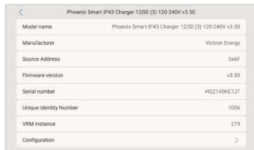
L'instance des DGN correspondants peut être modifiée dans le sous-menu Configuration.
